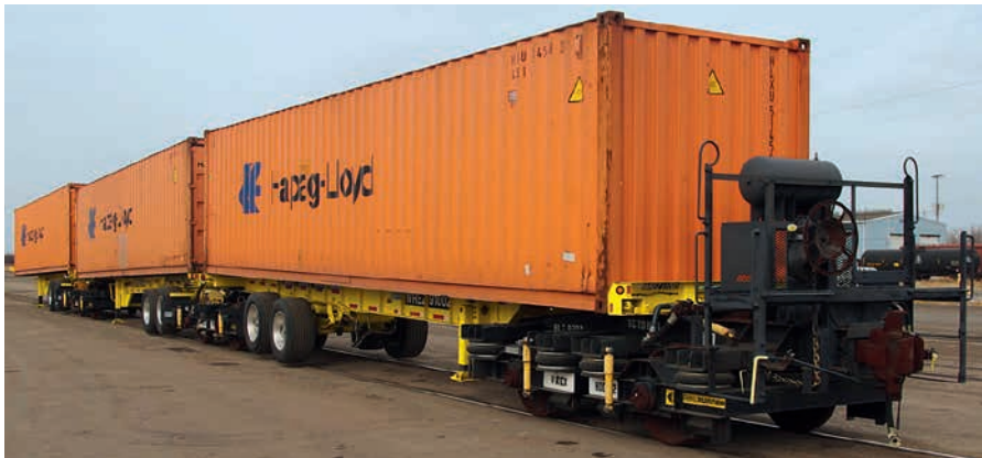
Railrunner-Fahrzeuge, vorne das Transfer-Drehgestell
