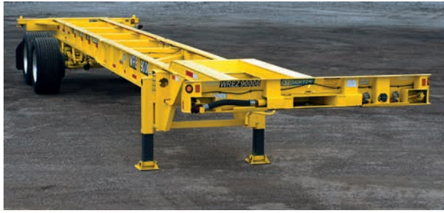
Das Chassis mit der mittigen Aufnahme für die Führungsnase des Drehgestells sowie den Luftanschlüssen
