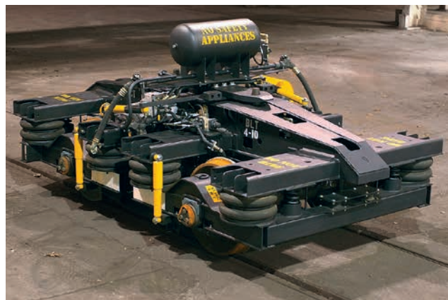
Das Mitteldrehgestell, mittig vor dem Luftbehälter ist die Führungsnase mit dem Bolzen für das Straßenfahrzeug zu erkennen.
