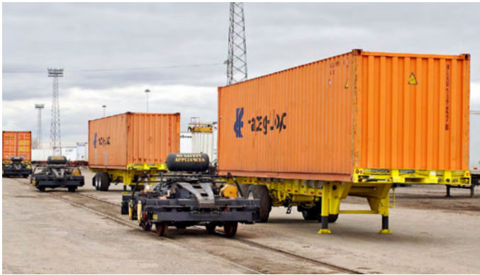
Bild 3: Die Drehgestelle werden jeweils zwischen zwei Sattelanhänger gekuppelt und machen das System schienenentauglich.
