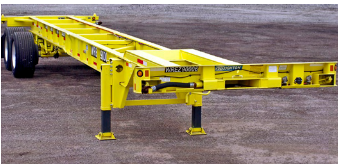
Bild 1: Ein spezielles Auflieger-Chassis ist in Längsrichtung verstärkt, weist zum Kuppeln eine zusätzliche Tasche auf und ist mit einer durchgängigen Zugbremsleitung ausgestattet.
