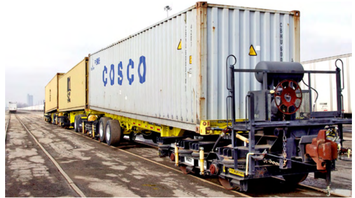
Bild 4: Ganzzüge im Railrunner-System können bei gleicher Länge rund 20% mehr Sattelanhänger aufnehmen als Huckepack-Züge mit konventionellen Taschen- oder auch Tragwagen.
