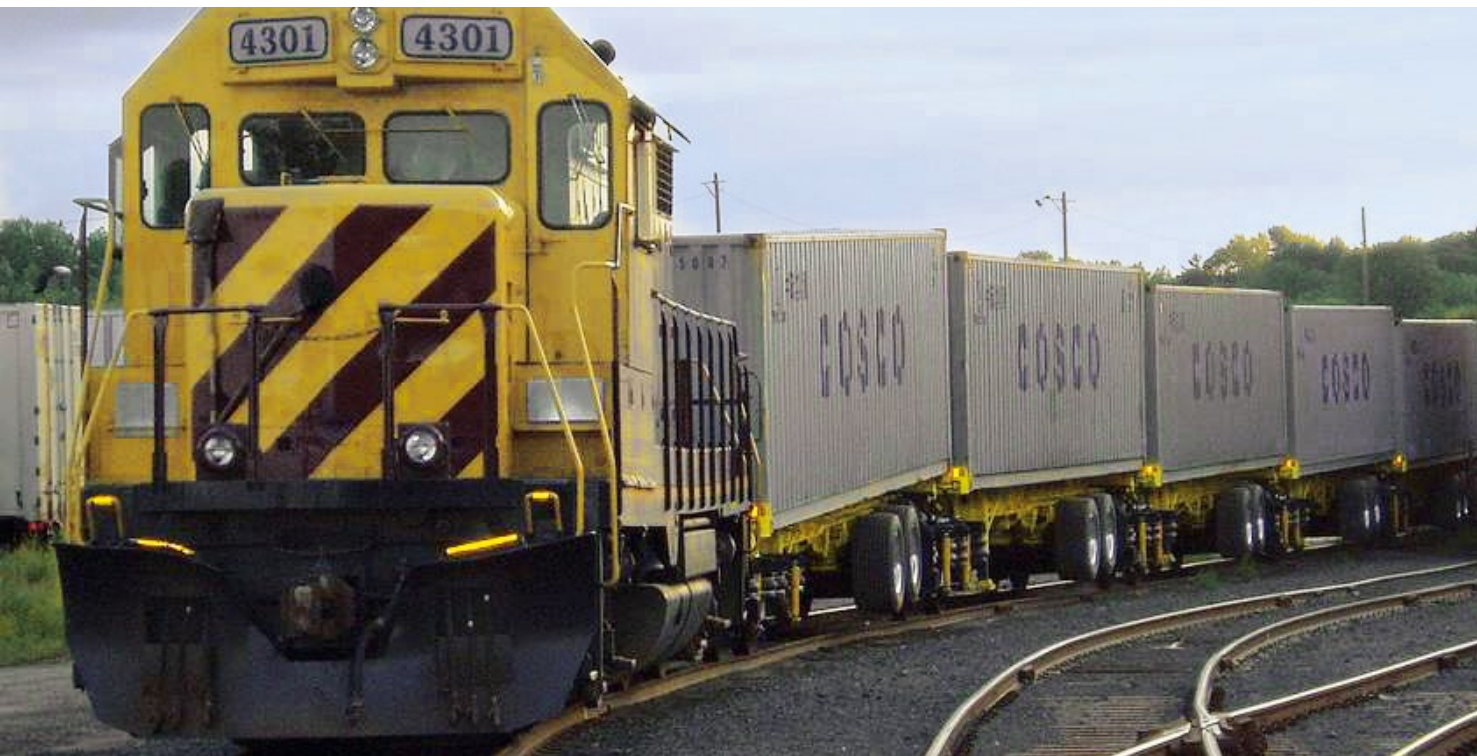
Ein Railrunner-Zug mit der in den USA üblichen leichten Neigung der verladenen Trailer: In Europa werden die Einheiten absolut waagrecht laufen, versichert der Anbieter.
